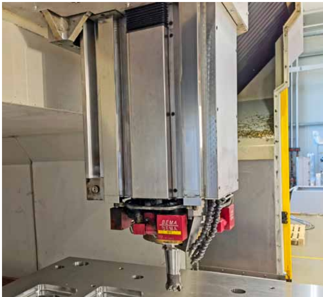
四角各配有四条导轨的 Quadroguide 原理赋予了 Z 轴特别高的刚性 (照片: Klaus Vollrath)。
