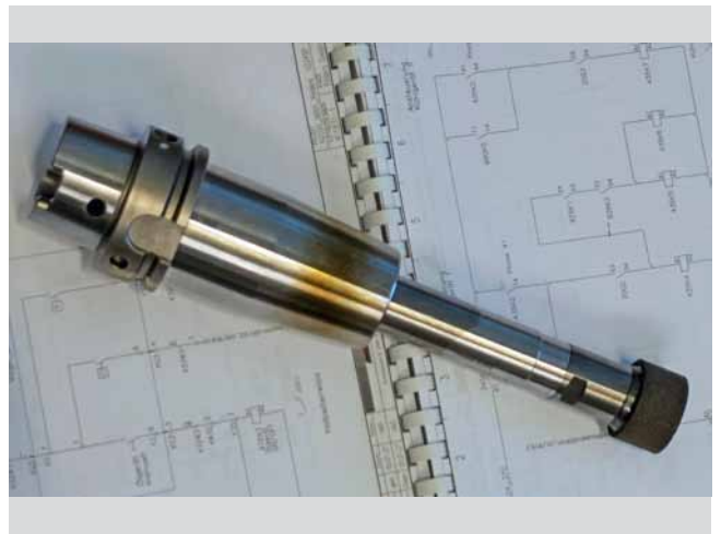
双重功能：除了铣刀和钻头，克雷布斯和里德尔的磨削销和磨轮也在此应用中使用 (照片: Klaus Vollrath)。
