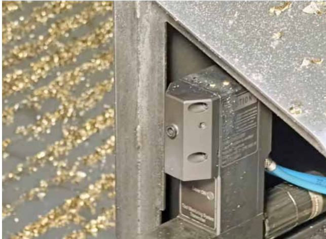
用于工具测量的激光单元只是该系统用来监控自身并优化加工过程的众多测量设备之一（照片：Klaus Vollrath）。
